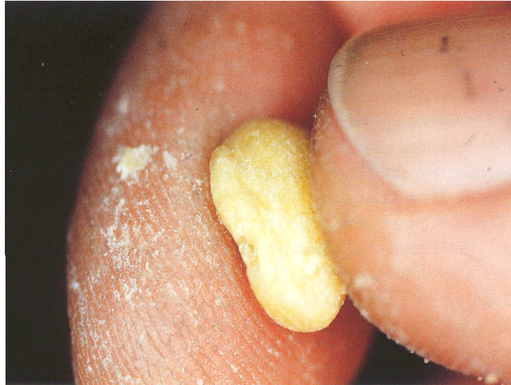
De kneedproef van bijenwas. Het beetje bijenwas dat aan de vingers blijft plakken wordt veroorzaakt door de eeltlaag van de huid.
